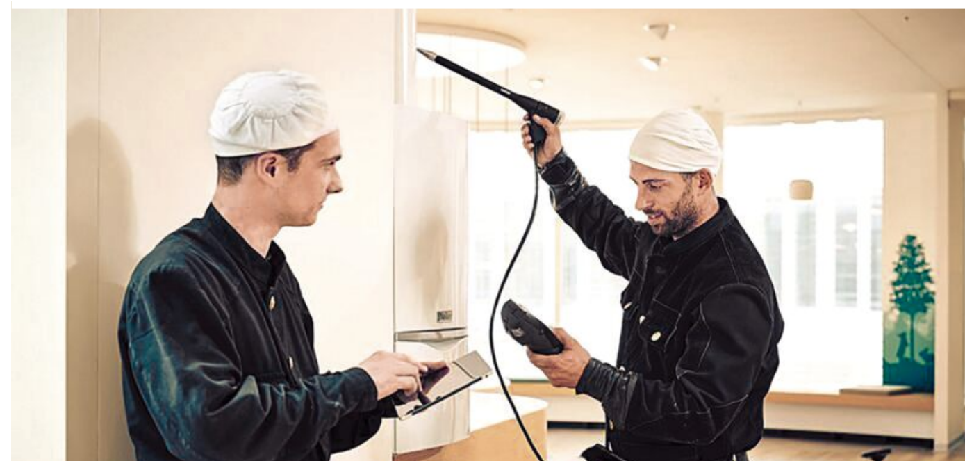
Rauchfangkehrer bei der Abgasmessung an einer Gasetagentherme in einer Wohnung
